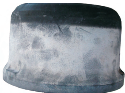
Brännmärken och anlöpningsfärger med begynnande värmesprickbildning
