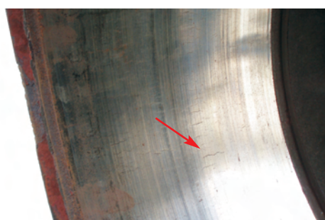
Brännmärken och anlöpningsfärger med begynnande värmesprickbildning
