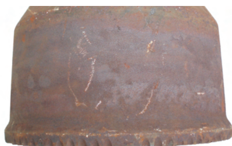
Brännmärken och anlöpningsfärger med begynnande värmesprickbildning
