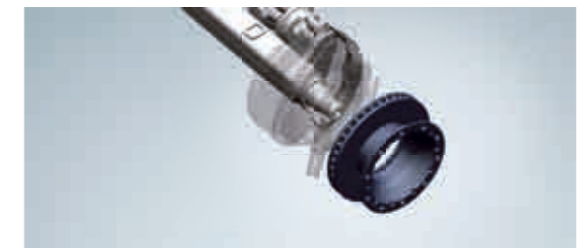
ECO Disc: enklare och snabbare byte av bromsskiva utan att bromsoket behöver demonteras.
