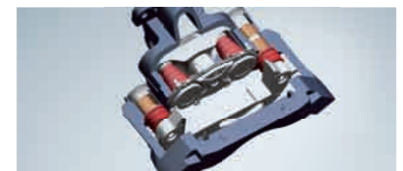
Sörjer för optimalt skydd: de moderna, inbyggda gummibälarna.
