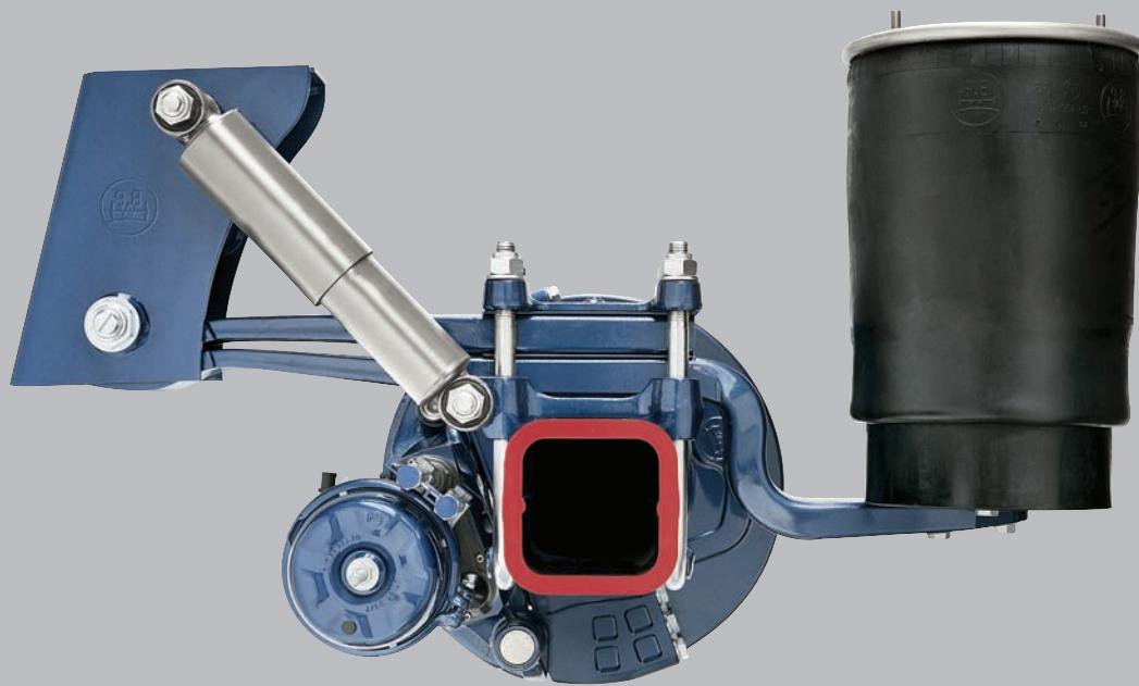
Stötdämpare bör endast monteras och bytas axelvis. På ett fordon med flera axlar får det sitta olika stötdämpare på de enskilda axlarna. Stötdämparen 02.3722.14.00 finns fortfarande som reservdel.
