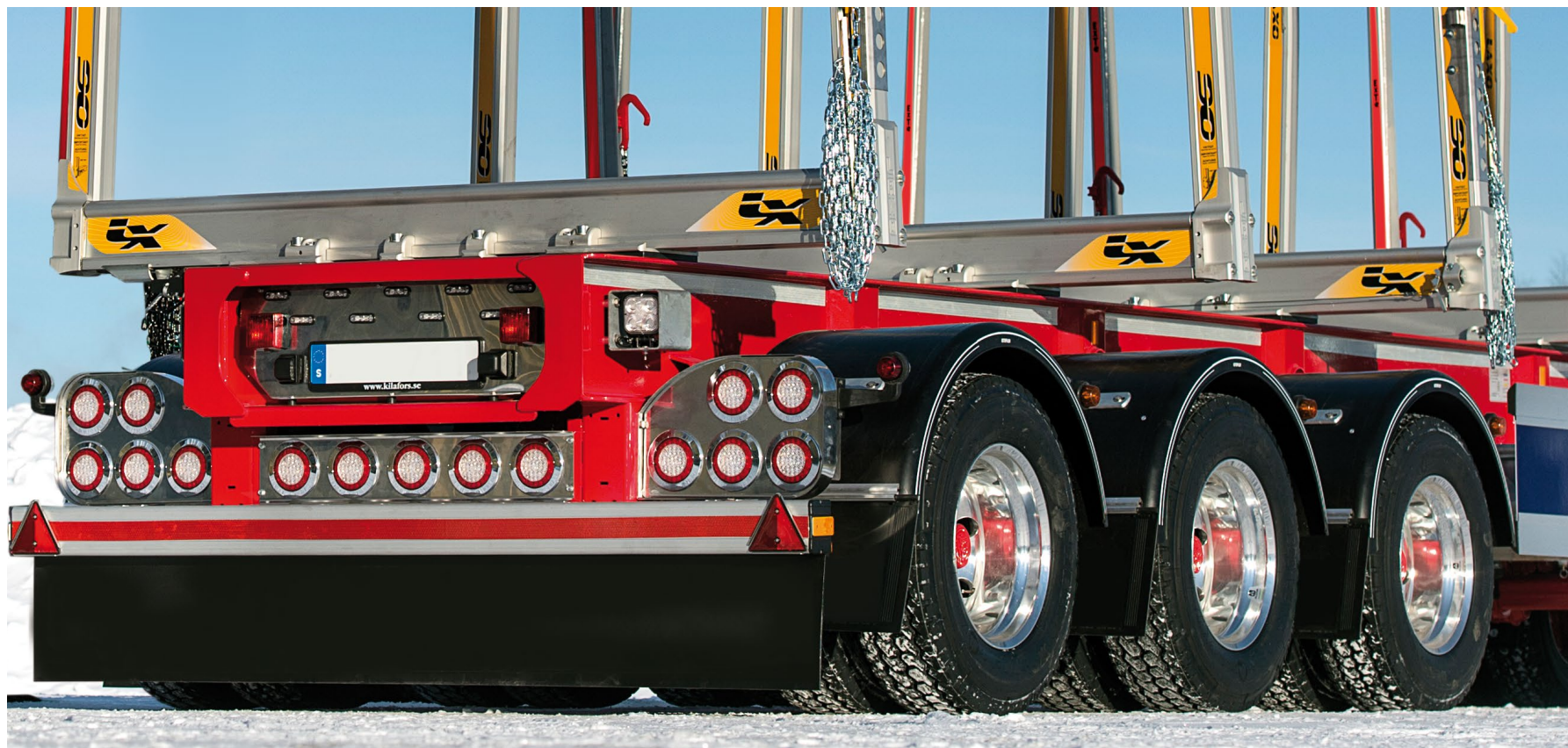
Vagnen på bilden är utrustad med axlar från BPW, Goodyear däck med Alcoa fälgar och Jokon belysning.
