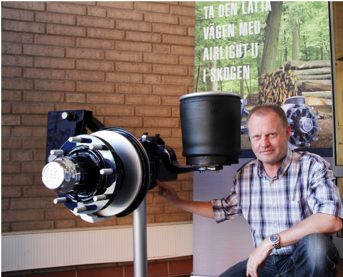
Claes Troedsson visar de förstärkta detaljerna på Airlight II. På närbilderna syns svetsad fjäderbädd och skivbromstäcklock i metall.
