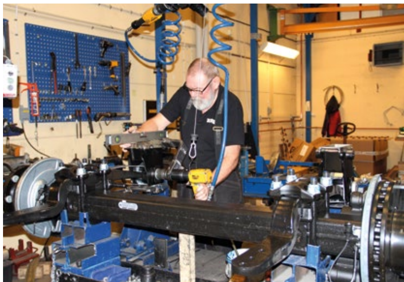
3. Fjäderbultarna dras åt med en momentdragare.
