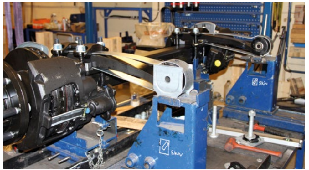
2. När fjäderkramporna är åtdragna, läggs slitbrickorna på plats, innan det är dags att montera främre fästen.
