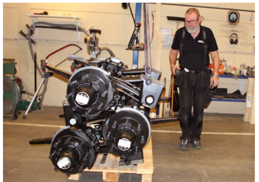
6. Tre moduler färdigbyggda och klara för leverans till en svensk släpvagnsbyggare.
