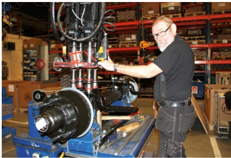
1. Axeln läggs i riggen och rätt fjäder läggs på. Fjäderkramporna dras till rätt moment med en 4-spindlig maskin.
