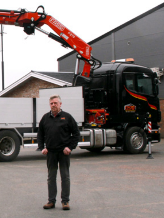
Kranbilen har utrustats med ett komplett flak i aluminium.
