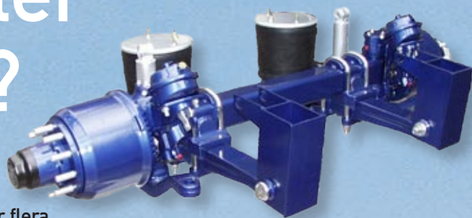
En tvångsstyrd axel har ända upp till 43 grader styrutslag
